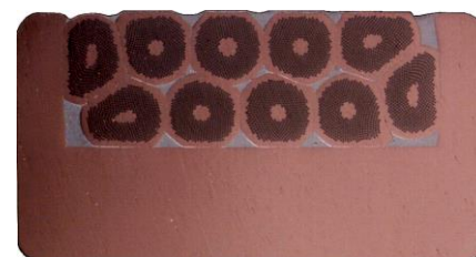
Câble supraconducteur en goulotte pour la bobine principale (9,2 mm x 4,9 mm) comportant 10 brins de fil composite NbTi-Cu insérés et soudés dans une goulotte en cuivre. © CEA-Irfu
