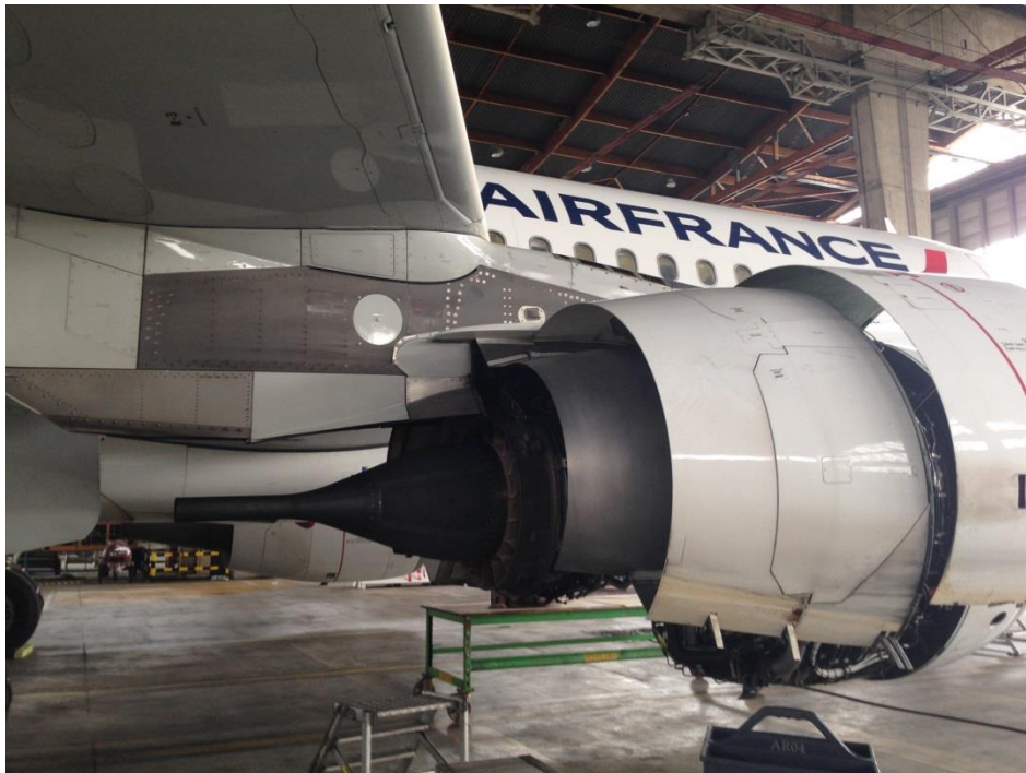
Cône d'éjection en composite à matrice céramique. © SAFRAN
