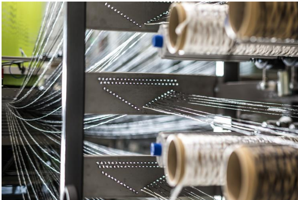
Métier à tisser la fibre de carbone utilisée pour la fabrication du moteur LEAP. ©Adrien Daste/SAFRAN
