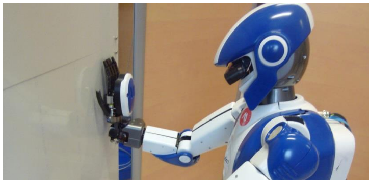
Un robot humanoïde vérifiant la fonctionnalité d'un panneau de commande. ©Joint Robotics Laboratory (CNRS/AIST)/AIRBUS SAS 2015
