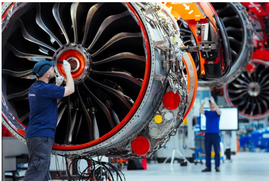
Ligne d'assemblage dédiée à l'assemblage final du moteur LEAP. ©Cyril Abad/CAPA Pictures/SAFRAN
