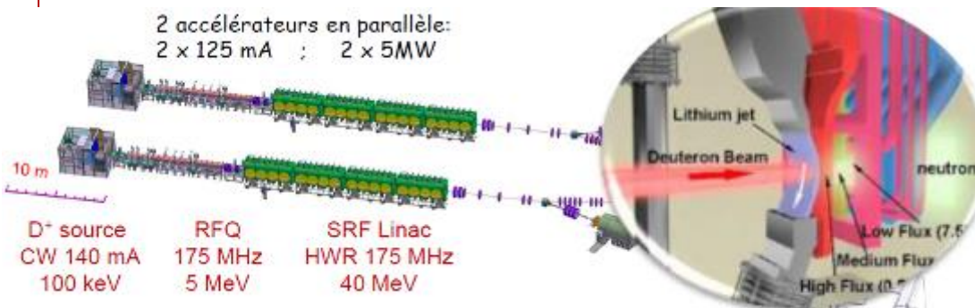
Schéma de principe du double accélérateur d'Ifmif, de la cible en lithium permettant la production de neutrons énergétiques et des cellules blindées pour l'irradiation des matériaux
