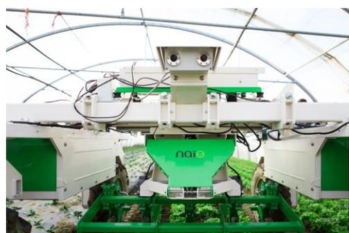
Des présentations du **robot Dino** (Naïo Technologies) auront lieu durant le Salon. Cet enjambeur est spécialisé dans le désherbage mécanique et pourrait intégrer les champs de céréales dans le futur. Capable de se guider grâce à la technologie RTK (avec une précision de quelques centimètres), il dispose également de caméras lui permettant de détecter les cultures. Les visiteurs pourront le voir installé parmi des rangs de maïs.
