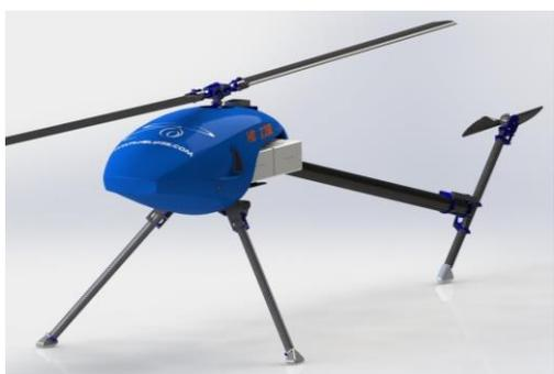
Bioline Agrosiences et Agribird exposeront un **drone**, suspendu au-dessus d'une parcelle de maïs. C'est ce type de matériel qui est utilisé en conditions réelles pour larguer de manière autonome des capsules contenant des œufs de trichogrammes, minuscules guêpes chargées de lutter contre la pyrale du maïs. Le distributeur qui sera en démonstration est capable d'éjecter simultanément trois billes (une sous l'appareil et deux propulsées sur les côtés).
