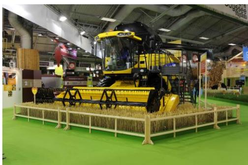
Une moissonneuse-batteuse New Holland sera présente sur le stand (modèle CX5080). Cette machine connectée dispose d'un équipement GPS permettant son guidage, mais également la réalisation de cartographies. La moissonneuse peut échanger des informations avec le bureau de l'agriculteur et collecter de nombreuses données sur la récolte grâce à des capteurs embarqués (notamment l'humidité et le rendement).
